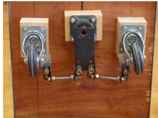
図3 ハンドル部分と前輪の舵取り機構
