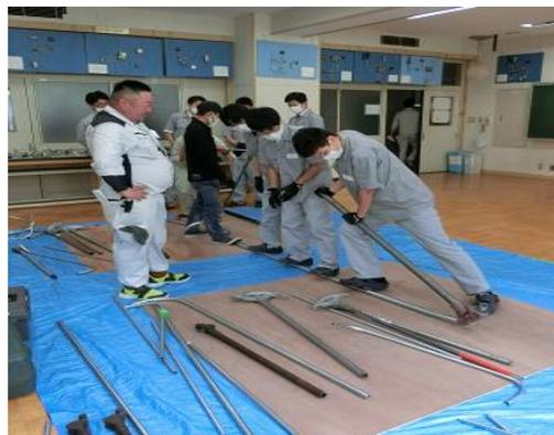
厚鋼電線管 G22 曲げ作業④
